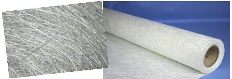
Abb. 1+2: Unsere pulvergebundene Glasfasermatte. Rechts auf Rolle, links im Detail.
